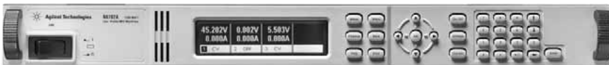
Рисунок 3 - Передняя панель с индикацией до 4-х каналов одновременно (на рисунке показаны 3 установленных канала)
